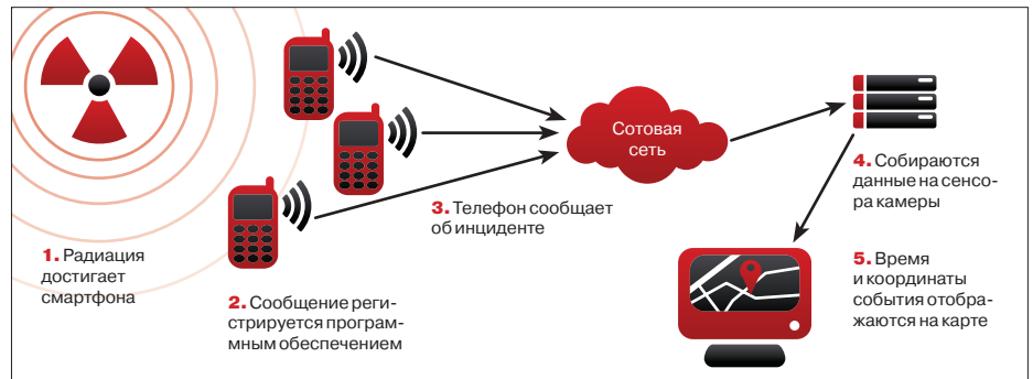
Рис. 1. Схема работы системы CellRAD
